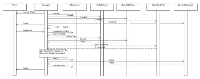
Il diagramma di sequenza permette la rappresentazione delle interazioni tra le varie classi del modello di business e ne descrive l'ordine di esecuzione indicando, con una freccia, i messaggi scambiati tra le classi. Sopra ogni freccia viene indicato il nome del comportamento destinatario del messaggio.
